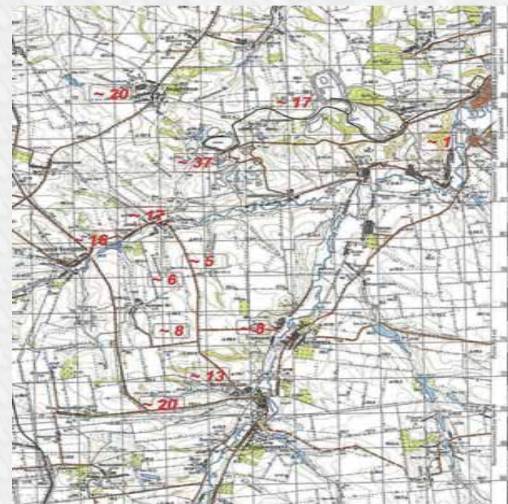
Die wichtigen Lagerstätten liegen südwestlich der Stadt Drushkovka (12). Die Tonlagerstätte von Chasov Yar liegt etwa 20 km östlich von Drushkovka und enthält ca. 20 Mio. t an Tonvorräten. Die Gesamtreserven der in der Karte verzeichneten Lagerstätten summiert sich auf über 150 Mio. t. Dem Geologischen Dienst der Ukraine zur Folge werden bekannte und bereits teilweise explorierte Vorkommen auf über 1.000 Mio. t geschätzt. Weiterhin zunehmende Nachfrage nach ukrainischem Ton sind gewinnungstechnisch also keine Grenzen gesetzt.
