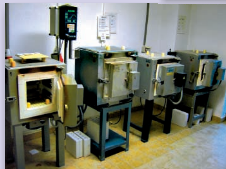
Elektrisch beheizte Laboröfen (normale Brennzeit auf 1200°C: 12 h)
