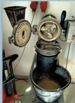
Schlagkreuzmühle zum Mahlen von trockenen Tonproben
