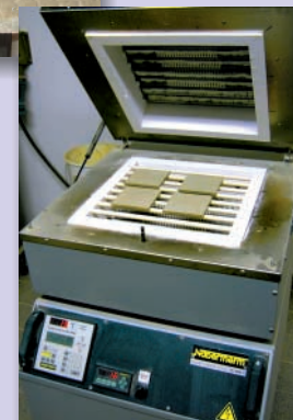
Elektrisch beheizter Laborschnellbrandofen (2 h)
