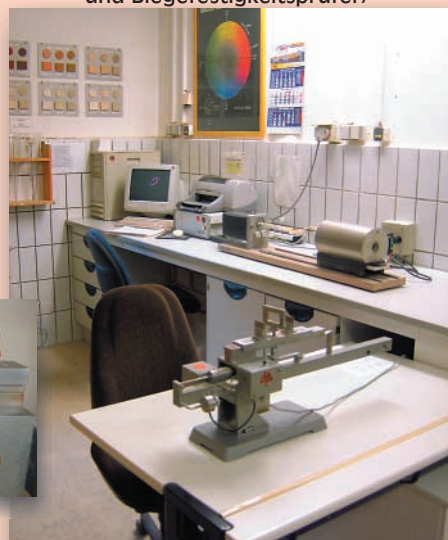
Laborraum mit Messgeräten (u.a. einem Dilatometer und Biegefestigkeitsprüfer)
