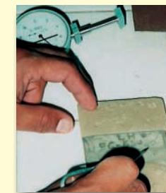
Einritzen der Probenbezeichnung
