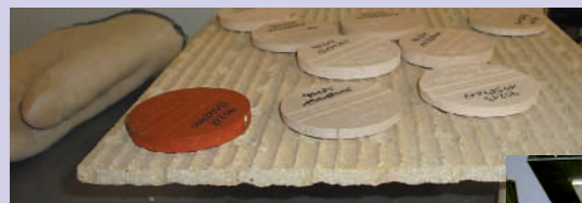
Gebraunte Probeplättchen auf feuerfester Unterlage (aus Cordierit)
