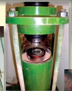
Einfache hydraulische Presse für runde Probeplättchen
