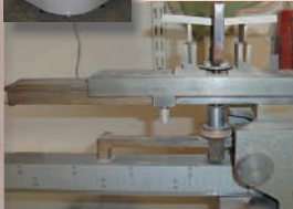
Prüfung der Trockenbiegefestigkeit
