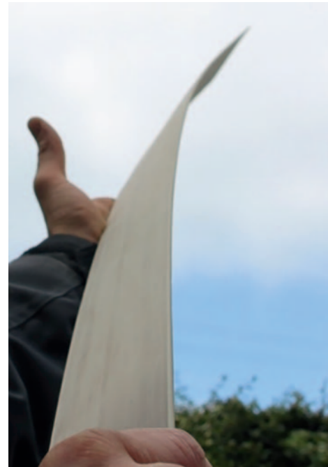
Mit Westerwälder Ton möglich: stranggezogene Fliese, gebrannt, ca. 2m lang, 3,3 mm dick. Ohne ausreichende Trockenbiegefestigkeit nicht machbar.
