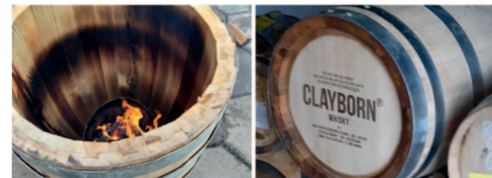
Mit einem speziellen Verfahren wurde dann ein Fass mit doppellagigen Dauben gebaut: Tonholz innen, Eiche aussen.
