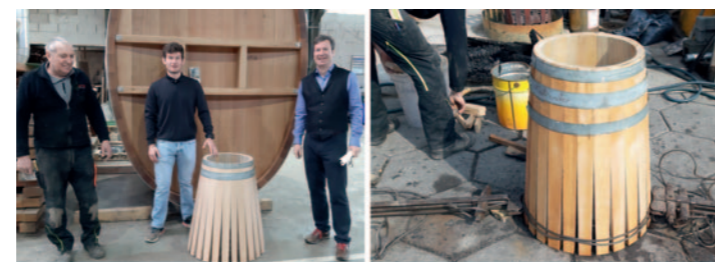
Mit einem speziellen Verfahren wurde dann ein Fass mit doppellagigen Dauben gebaut: Tonholz innen, Eiche aussen.
